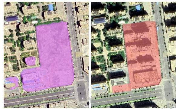
图1 模型辅助标注过程示意图 (a)模型预测的变化区域 (b)人工修订后的标注结果 (a) Model-predicted change regions; (b) Manually revised reference labels
